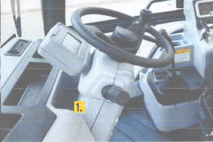
1. Ajuste da coluna de direção para cima, para baixo, para frente e para trás, garantindo ergonomia e conforto ao operador.
