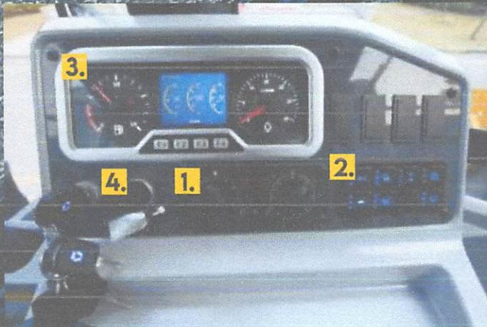
1. Ar condicionado de refrigeração e aquecimento inteligente de alta potência, função de manutenção de temperatura constante, configuração de temperatura auto-adaptativa e função de descongelamento por ar quente.
