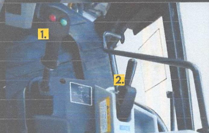
**1.** Caçamba com nivelamento automático durante o processo de levantamento do braço, com variação de até 1,5° na caçamba.
